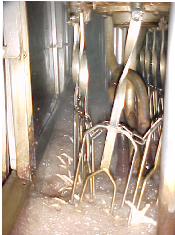
شكل (29) تغطيس الذبائح في الماء الساخن (52°م) - التسميط. لاحظ أرجل الذبائح الظاهرة في الحوض - منظر داخلي لأحواض التسميط .
