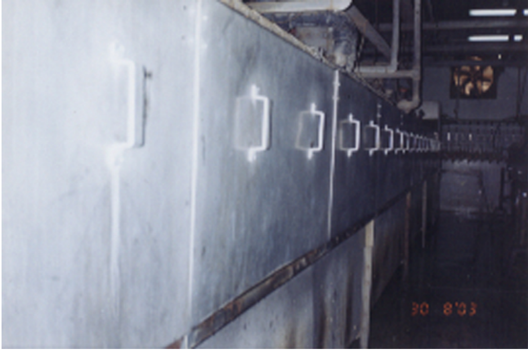
شكل (28) وحدات التسميط من الخارج (مغلقة) للحد من تلوث أرضيات المسلخ
