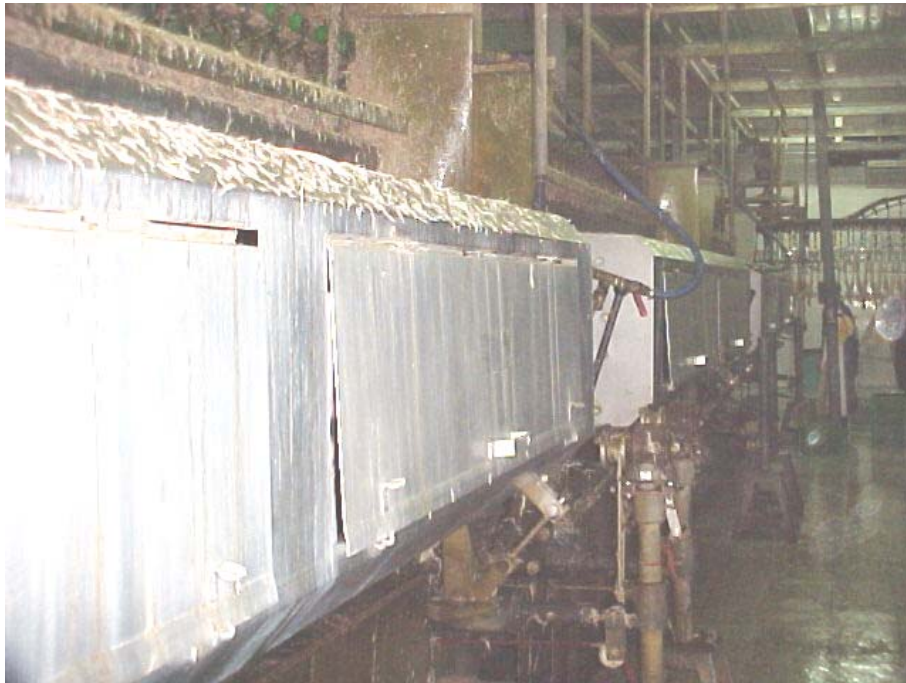
شكل (31) وحدات نزع الريش مغلقة لمنع تطاير الريش داخل المسلخ والتقليل من التلوث - منظر خارجي
