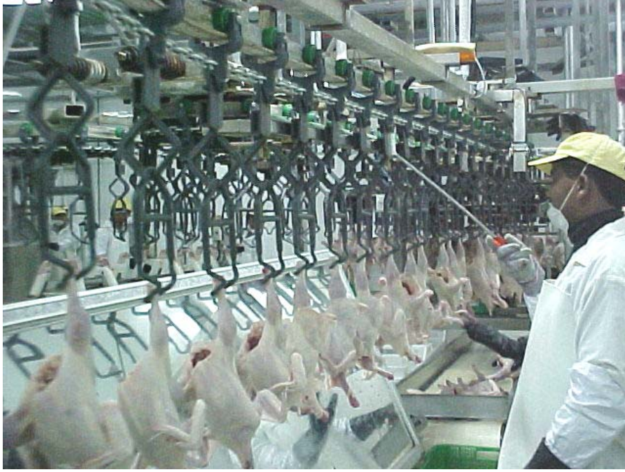
شكل (38) نقطة استبعاد الذبائح ذات الجودة الأقل بواسطة التأشير عليها بعضى معدنية على الخط المتصل بجهاز الحاسب الآلي
