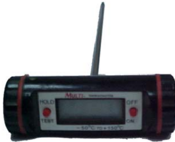
شكل (5) جهاز قياس درجة الحرارة في عمق اللحوم (المركز الحراري في العينة المراد قياس درجة حرارتها)
