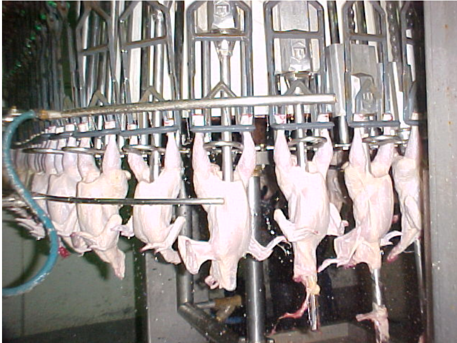
شكل (35) ماكينة نزع الأحشاء - لاحظ إنبوب دفع الأحشاء للخارج داخل الذبيحة من أعلى لأسفل الذبيحة
